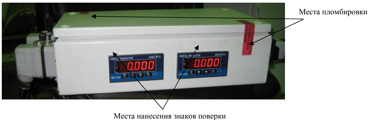
Рисунок 1 – Внешний вид цифрового прибора и схема его пломбировки от несанкционированного доступа.
