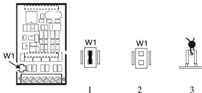
Рисунок 3 – Пример пломбировки W1 (1 – параметры калибровки защищены, 2 – параметры калибровки не защищены, 3 – свинцовая пломба)
