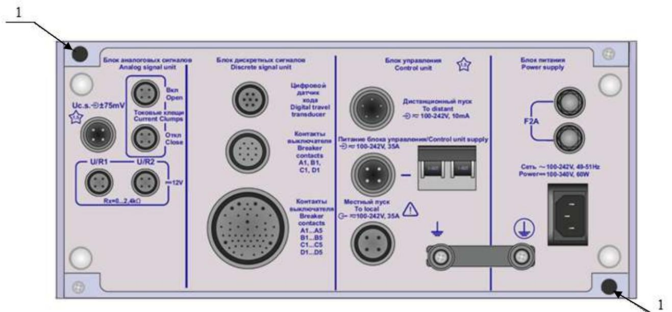
Рисунок 3 - Схема пломбировки от несанкционированного доступа (задняя панель измерительного блока ПКВ/У3.1)
