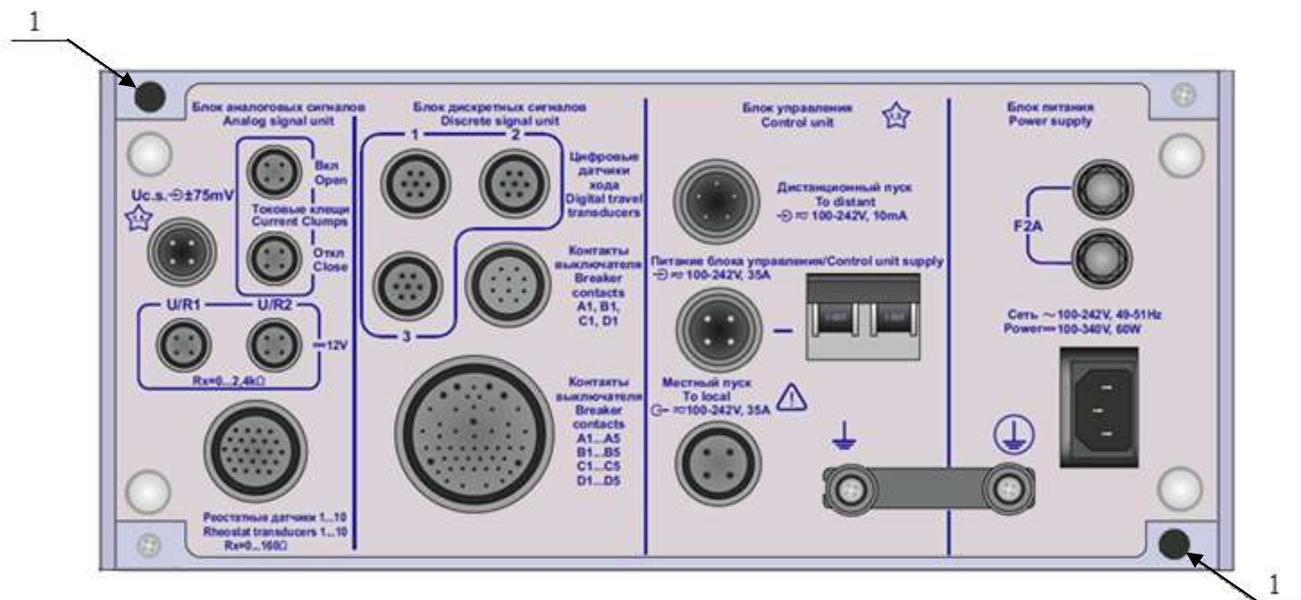
Рисунок 2 - Схема пломбировки от несанкционированного доступа (задняя панель измерительного блока ПКВ/У3.0)
