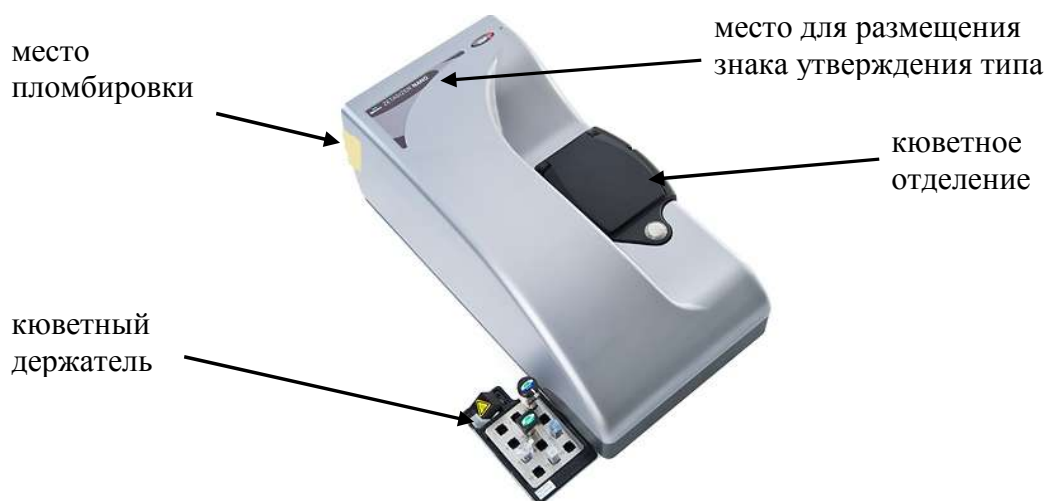
Рисунок 1 – Внешний вид, обозначение места для размещения знака утверждения типа и схема пломбировки от несанкционированного доступа анализаторов Zetasizer Nano ZPS, Zetasizer Helix
