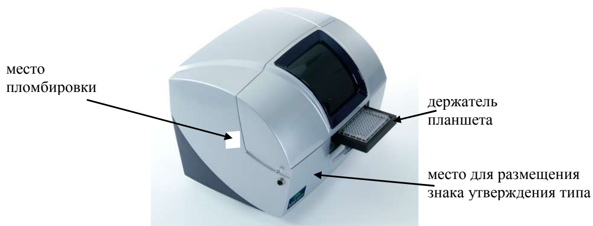
Рисунок 3 - Внешний вид, обозначение места для размещения знака утверждения типа и схема пломбировки от несанкционированного доступа анализаторов Zetasizer APS
