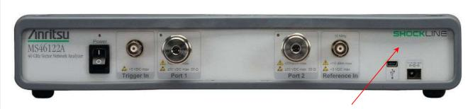
место нанесения знака утверждения типа и знака поверки Рисунок 1 – Вид передней панели анализаторов серии MS46122A
