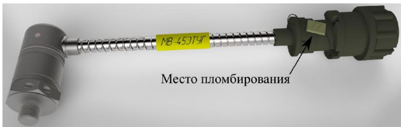
Рисунок 2 - Внешний вид MB-45Э. Угловой вариант исполнения
