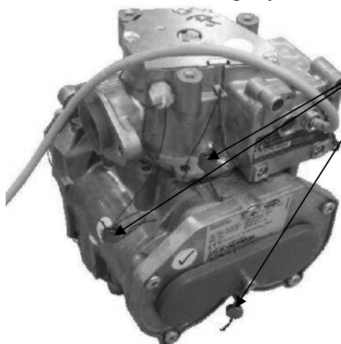
Рисунок 17 – Схема пломбировки измерителя объема с генератором импульсов, производства фирмы «Tokheim UK Ltd.»
