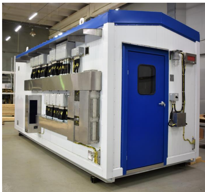
Рисунок 1 – Общий вид системы автоматизированной мониторинга выбросов загрязняющих веществ печей F-1, F-2, F-3 комплекса установки гидроизодепарафинизации ООО «Газпромнефть-СМ» «ОЗСМ»
