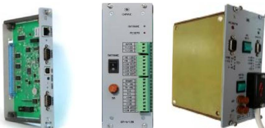
Рисунок 2 - Фотографии общего вида процессорного блока, БП-У/24Ш, БП-У/24
