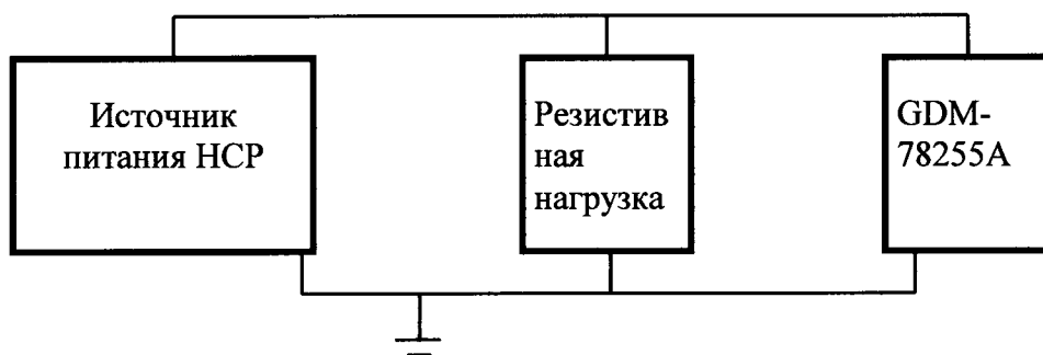
Рисунок 3 – Схема определения погрешности измерения напряжения при нагрузке, до 1000 В
