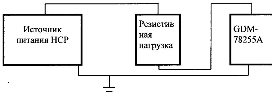
Рисунок 5 – Структурная схема соединения приборов для определения относительной погрешности измерения силы постоянного тока нагрузки
