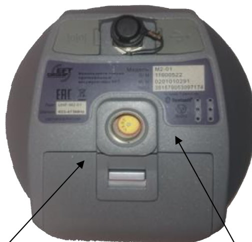
а – место пломбировки б – место нанесения наклейки со знаком утверждения типа (нижняя панель)
