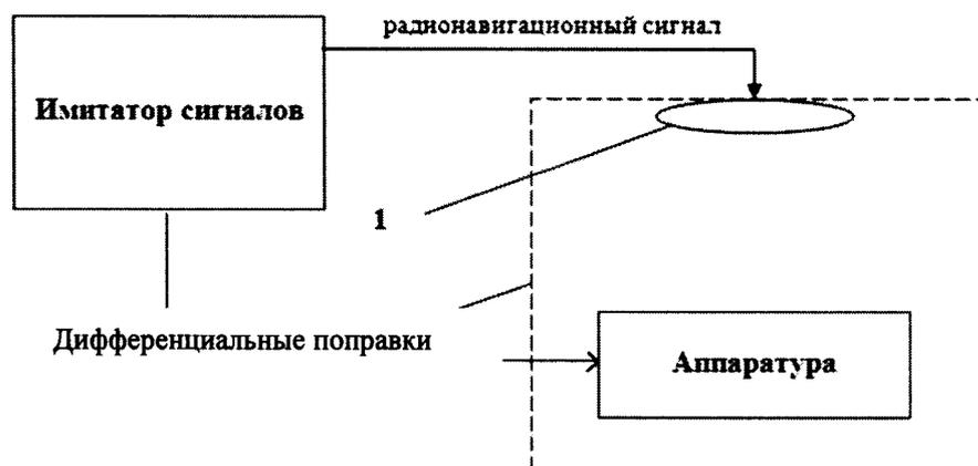
1 – переизлучающая антенна; 2 – экранированная камера (из состава имитатора сигналов)
