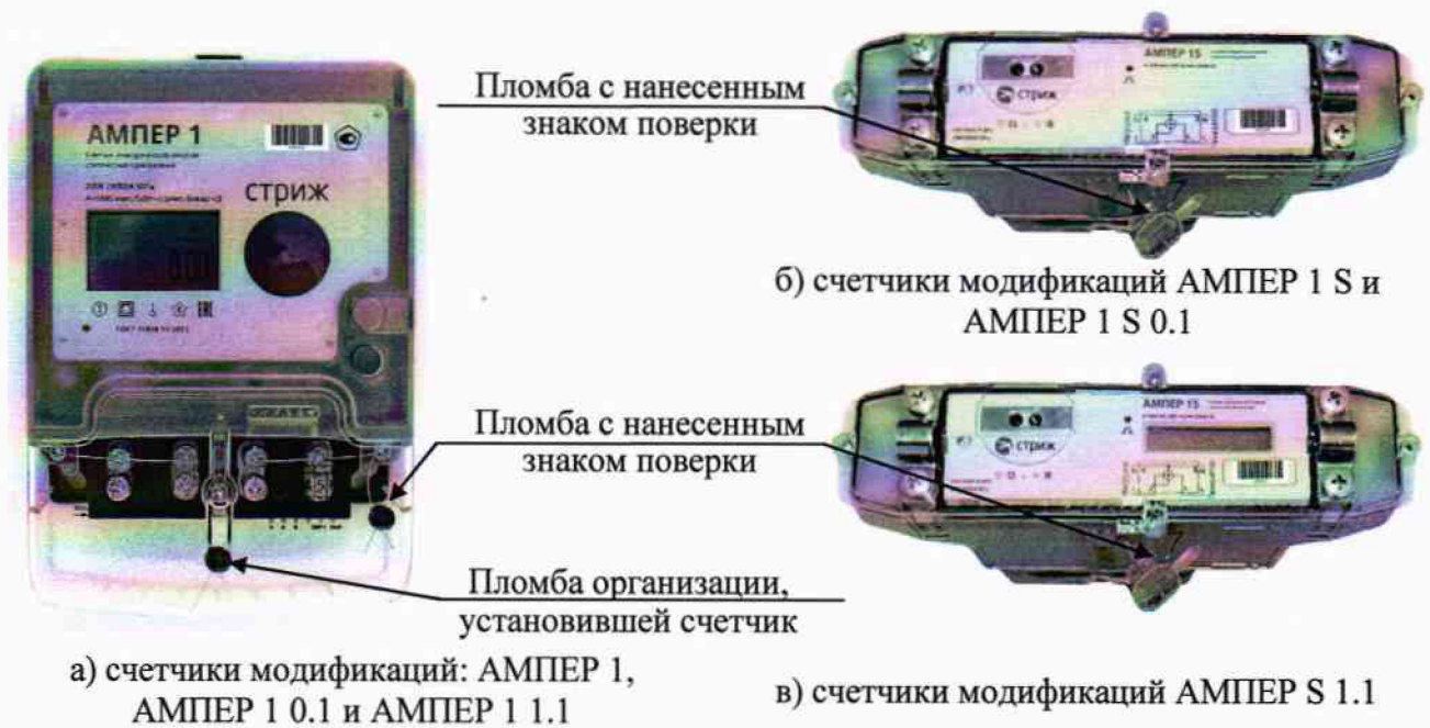
Рисунок 7.1 – Схемы пломбировки счетчиков
