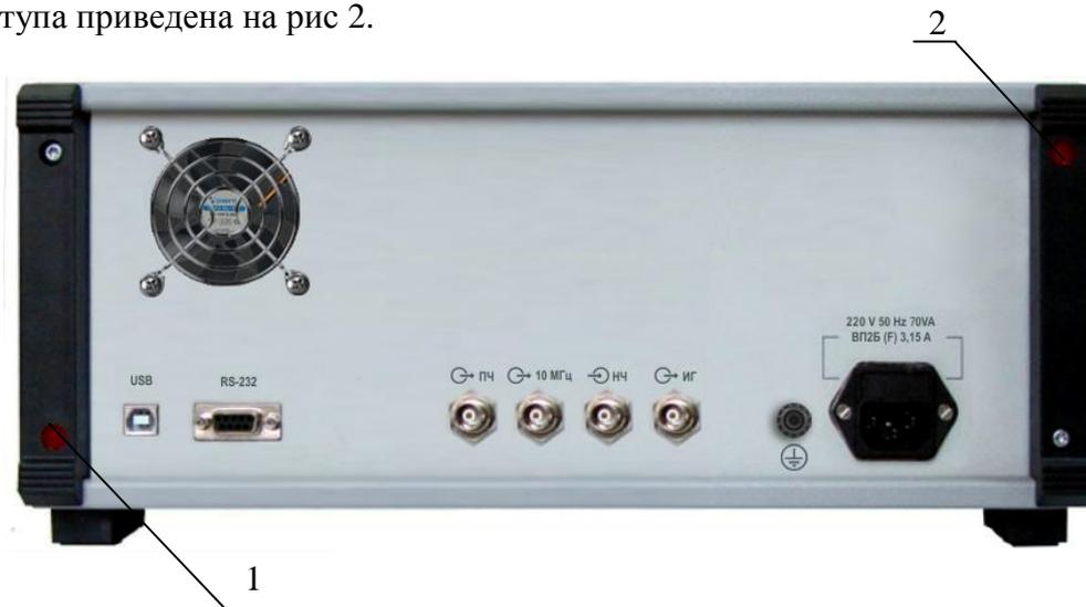
Позиции 1; 2 на схеме – места пломбирования измерителей с нанесением знака поверки.
