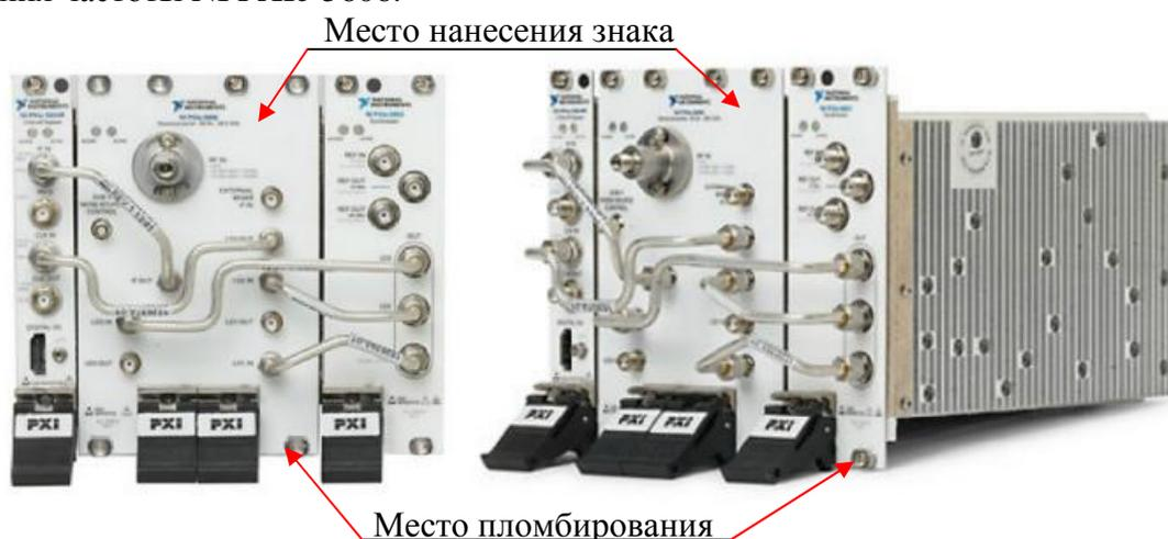
Рисунок 1 - Внешний вид анализаторов спектра NI PXIe-5668R
