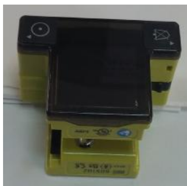
Рис. 3. Капнометр ЕММА с функцией графического отображения показаний в реальном времени (капнограф). Вид спереди
