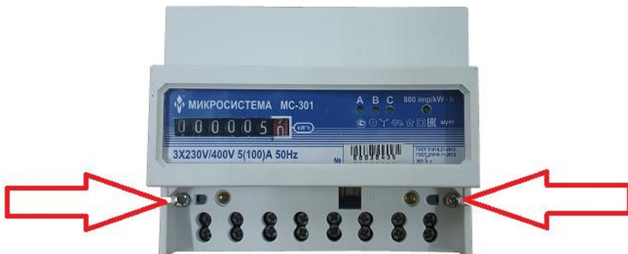
Место нанесения пломбы завода изготовителя
