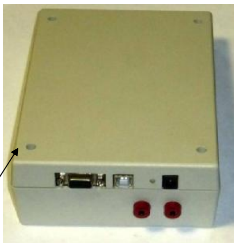
Рисунок 2- Место пломбировки от несанкционированного доступа
