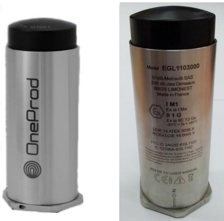
Рисунок 5 - Внешний вид вибропреобразователей измерительных OneProd EGL
