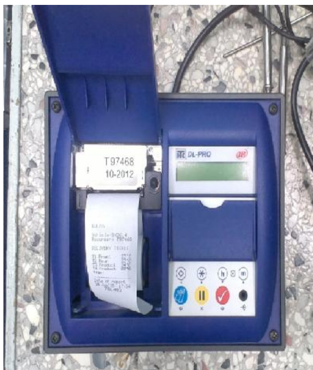
Рисунок 1 - Комплекс измерительный TKDL-PRO
