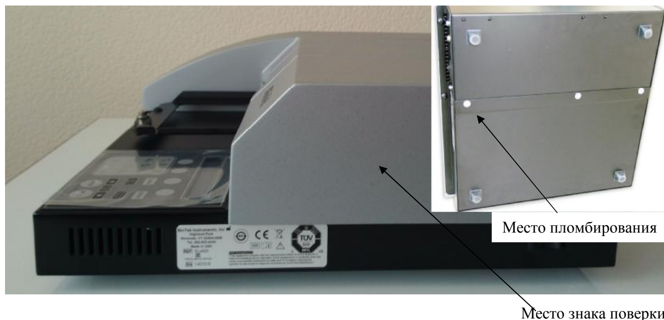
Рисунок 2 - Схема маркировки и пломбирования
