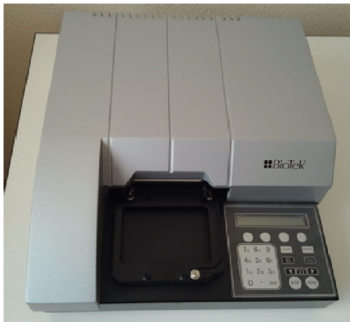
Рисунок 1 – Общий вид фотометров для микропланшет автоматических ELx800
