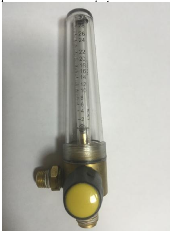
Рисунок 1 - Общий вид (фото) ротаметра RI.132.12541
