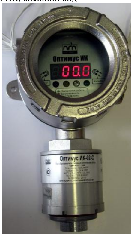
б) Оптимус ИК-УУ-С (корпус – нержавеющая сталь)
