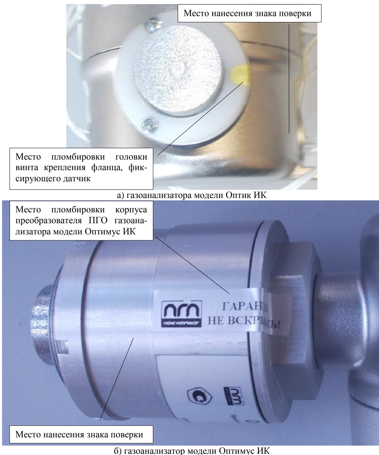
Рисунок 3 – Места пломбировки корпуса газоанализатора от несанционированного доступа
