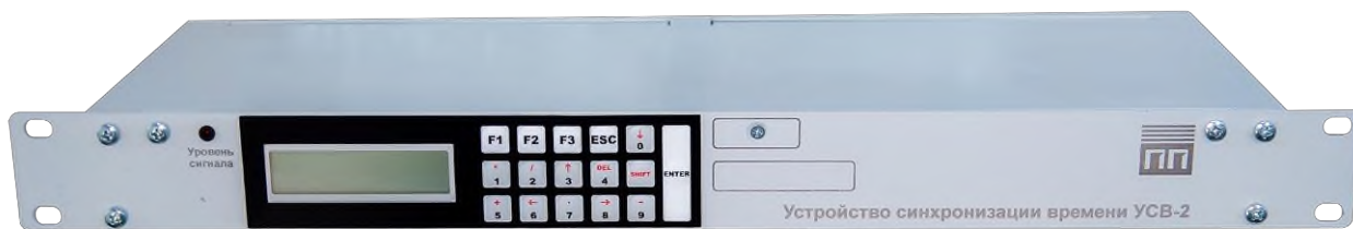
а) стоечное исполнение ВЛСТ 237.00.000, вид спереди
