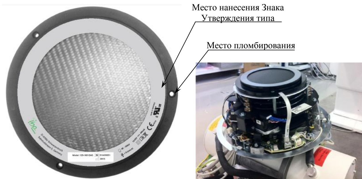
Рисунок 1 – Измеритель произведения дозы на площадь KermaX plus 120-160 EAS (вид сверху и размещение на диафрагме коллиматора рентгенографической установки)
