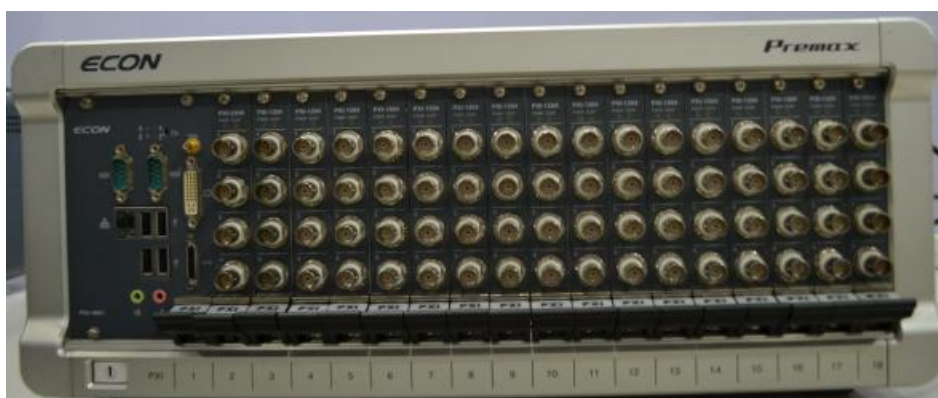
Рисунок 3 - Аппаратура измерительно-управляющая для вибрационных испытаний Premax модели MI-8018, 68 измерительных каналов
