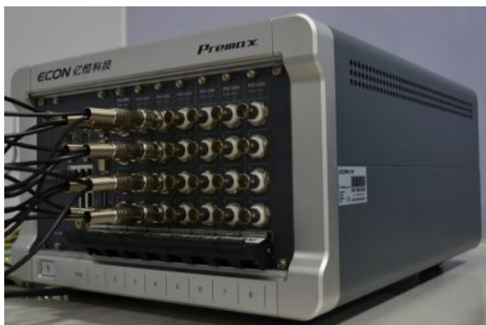
Рисунок 1 - Аппаратура измерительно-управляющая для вибрационных испытаний Premax модели MI-8008, 28 измерительных каналов
