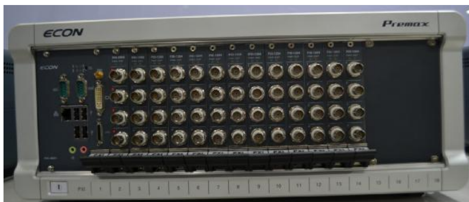
Рисунок 2 - Аппаратура измерительно-управляющая для вибрационных испытаний Premax модели MI-8014, 52 измерительных канала
