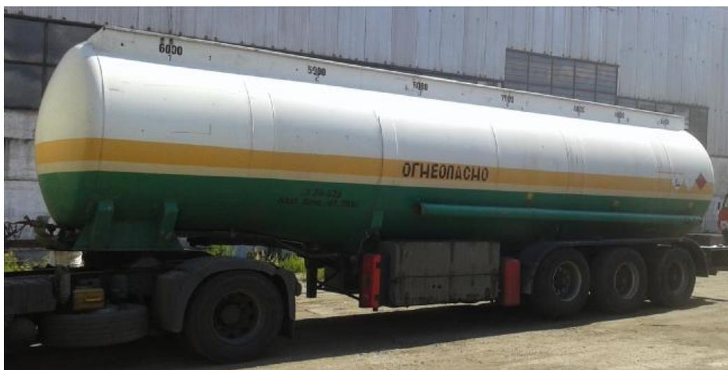
Рисунок 1 - Общий вид полуприцепа-цистерны ENERCO-ZREMB NC38/RDA03
