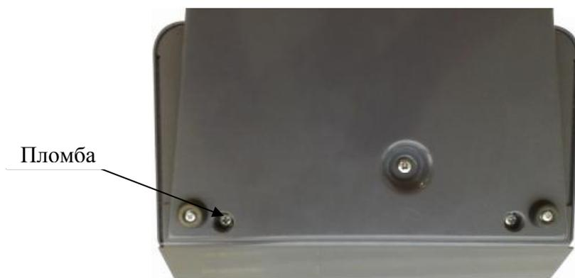
Рисунок 2 – Место пломбировки считывателя
