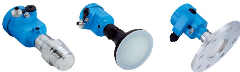
Рисунок 2 – Общий вид датчиков LBR (слева направо: с резьбовой рупорной антенной, пластиковой рупорной антенной, фланцевой герметизированной антенной)
