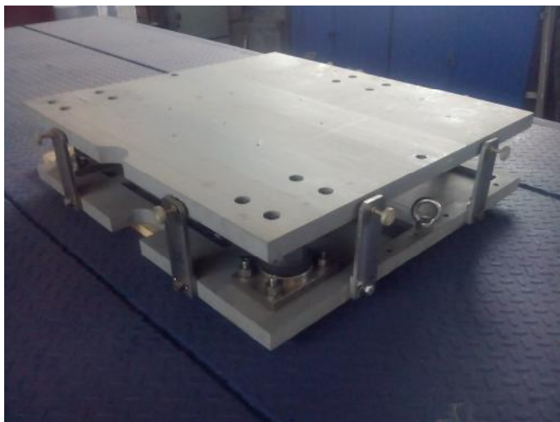
Рисунок 1 – Весы платформенные ВП
