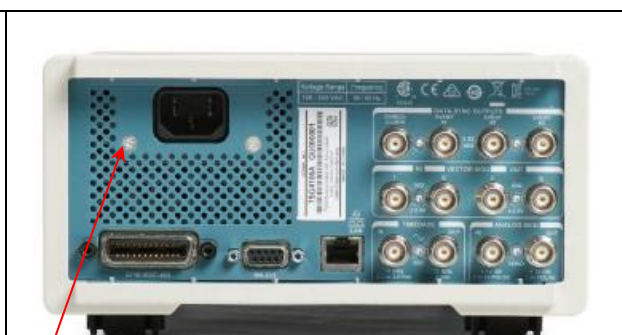
место пломбирования (краска под винт)
