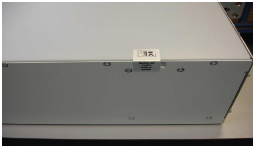
Рисунок 6 – Схема пломбировки источников от несанкционированного доступа
