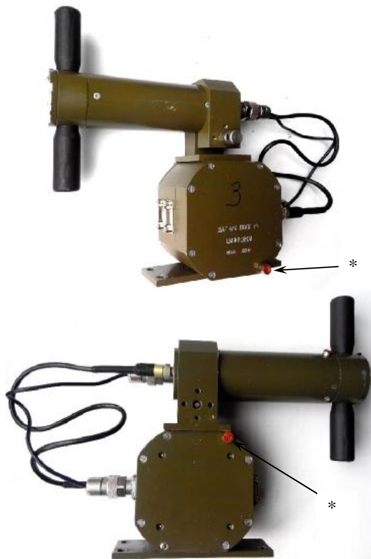
Рисунок 1 - Внешний вид датчика поля НЧ цифрового * - места пломбировки от несанкционированного доступа
