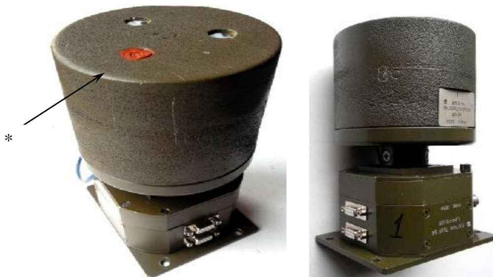
Рисунок 2 - Внешний вид датчика поля ВЧ цифрового * - место пломбировки от несанкционированного доступа
