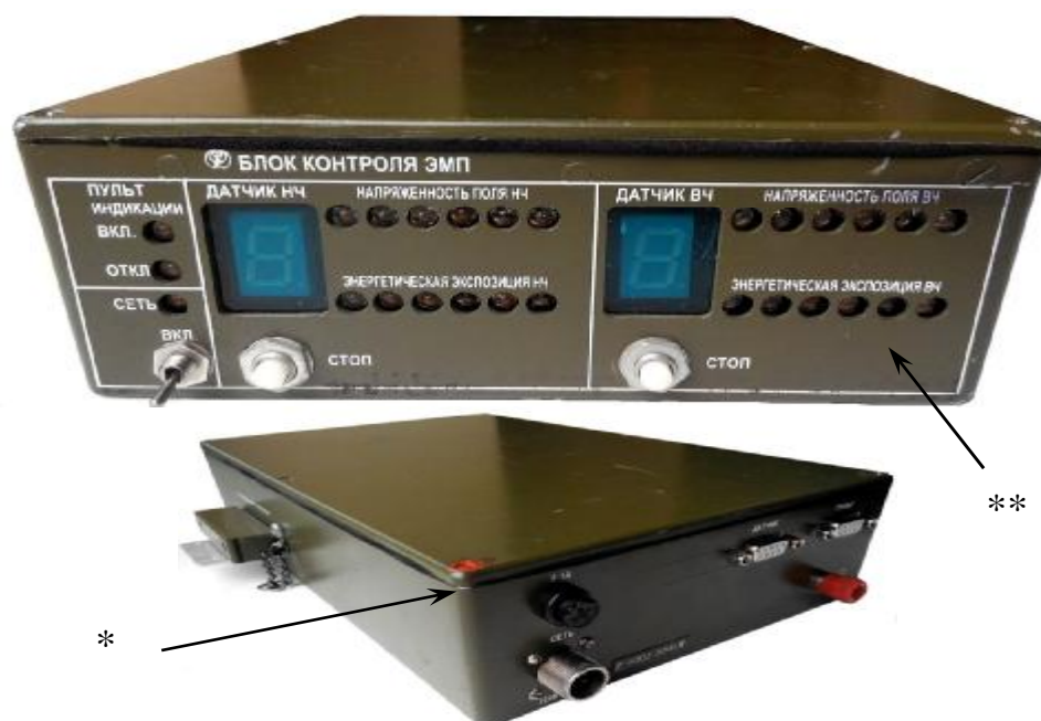
Рисунок 3 - Внешний вид блока контроля ЭМП * - место пломбировки от несанкционированного доступа ** - место для нанесения наклейки
