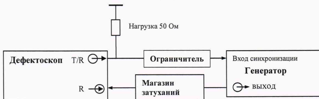
Рисунок 2 – Схема соединения для определения абсолютной погрешности измерений амплитуд сигналов на входе приемника
