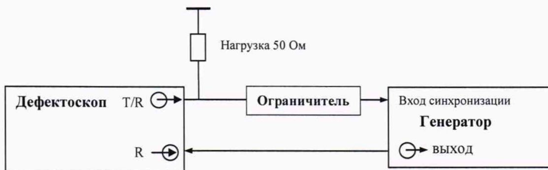
Рисунок 1 – Схема соединения для определения абсолютной погрешности измерений длительности временных интервалов
