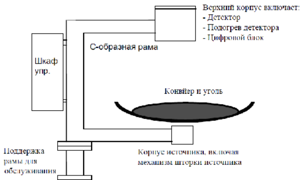
Рис. 2 Устройство анализаторов CoalScan
