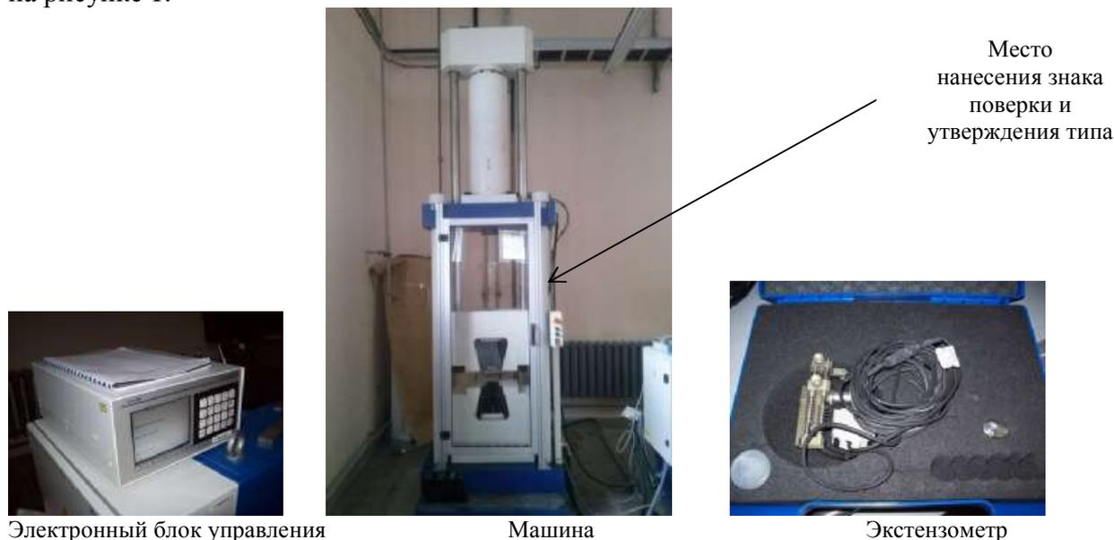
Рисунок 1 – Внешний вид машины, электронного блока управления и экстензометра
