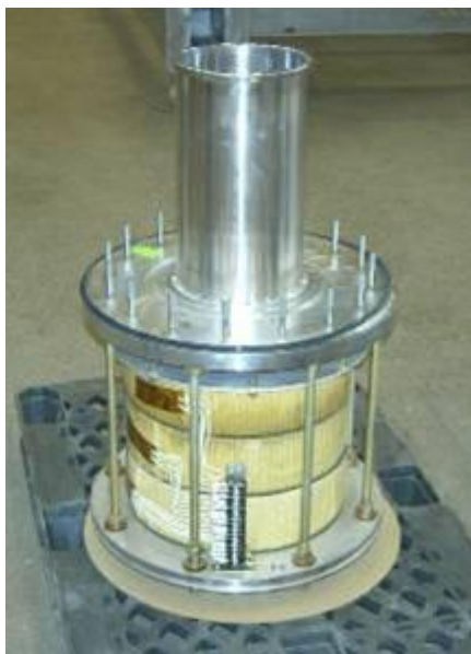
Рисунок 1 - Фотографии общего вида трансформаторов тока ТВГ-110-0,2S
