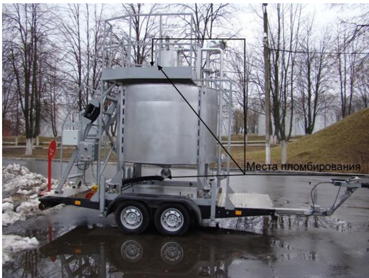
Рис. 1 Внешний вид и места пломбирования установок поверки систем налива передвижных УП-3.00.000
