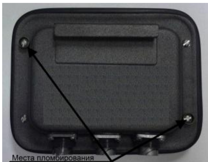
Рис. 1 Внешний вид и места пломбирования установок поверки систем налива передвижных УП-3.00.000
