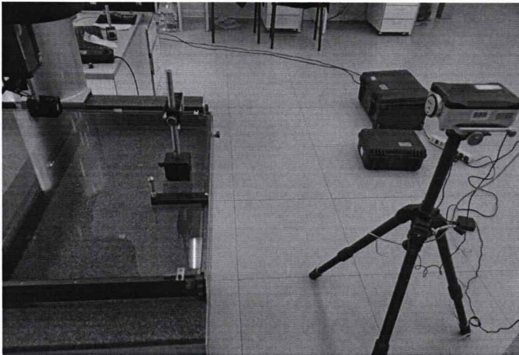
Рисунок 4 - Установка системы лазерной измерительной XL-80 в направлении оси Y для портальных микроскопов
