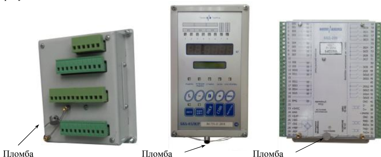
Рисунок 2 — Схема пломбировки от несанкционированного доступа
