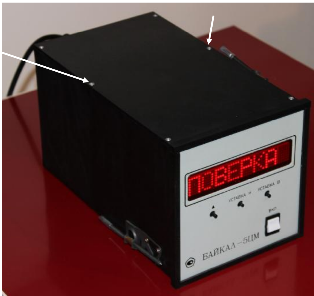
Рисунок 1 – Внешний вид гигрометра кулонометрического БАЙКАЛ-5ЦМ
