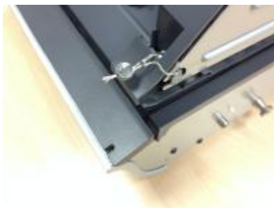
Рисунок 2 - Место пломбировки взвешивающего модуля.
