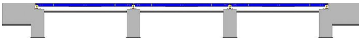
Рисунок 3 – Установка весов в приямок
