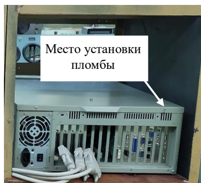
Рисунок 1 – Схема пломбировки от несанкционированного доступа
