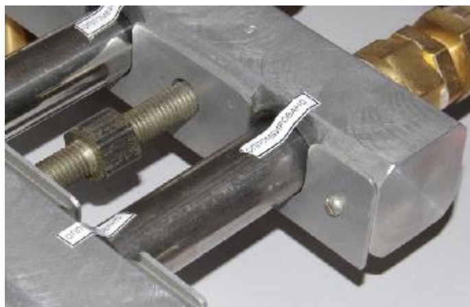
Рисунок 2 – Место пломбирования эталонных микросопел
