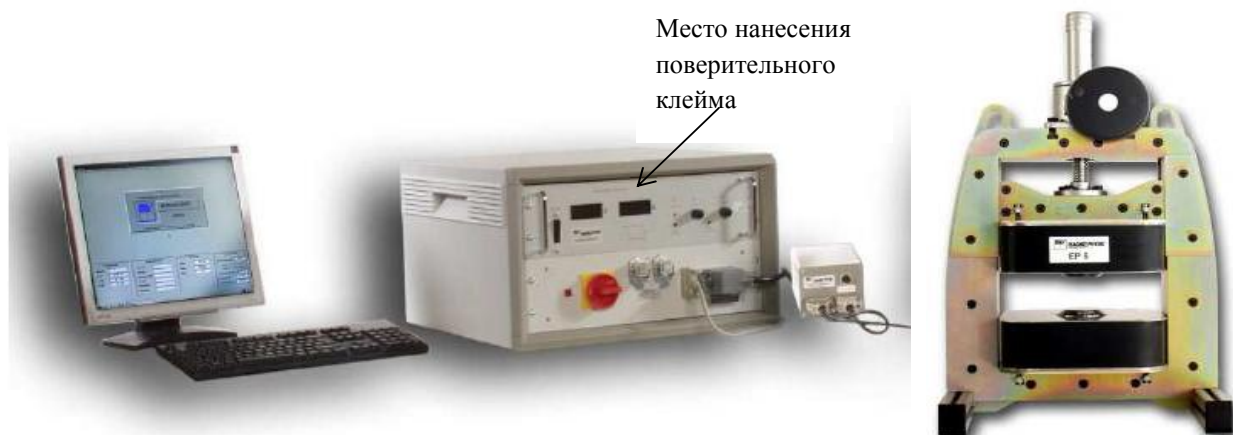
Рисунок 1 - Внешний вид гистерезисграфа с электромагнитом EP 5
