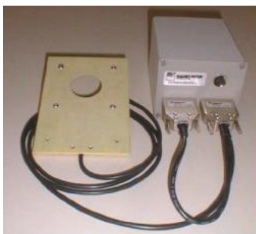
Рисунок 2 – Внешний вид измерительной катушки, подключенной к измерительному блоку ST-P-L
