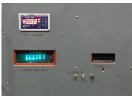
Рисунок 1 – Общий вид установки поверочной для счетчиков газа УПСГ-1000. Пульт управления.
