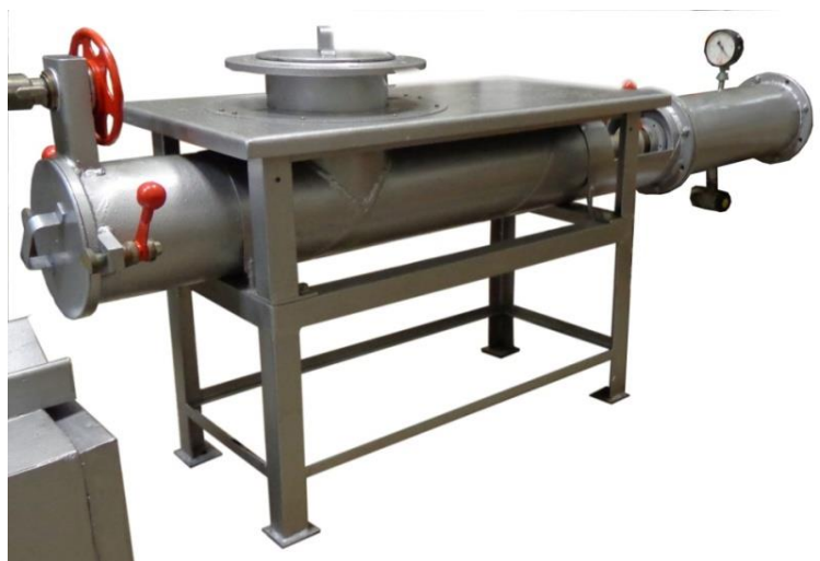
Рисунок 2 – Общий вид установки поверочной для счетчиков газа УПСГ-1000. Участок испытаний промышленных счетчиков.
