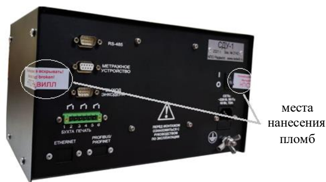
Рисунок 1 – Схема пломбировки от несанкционированного доступа
