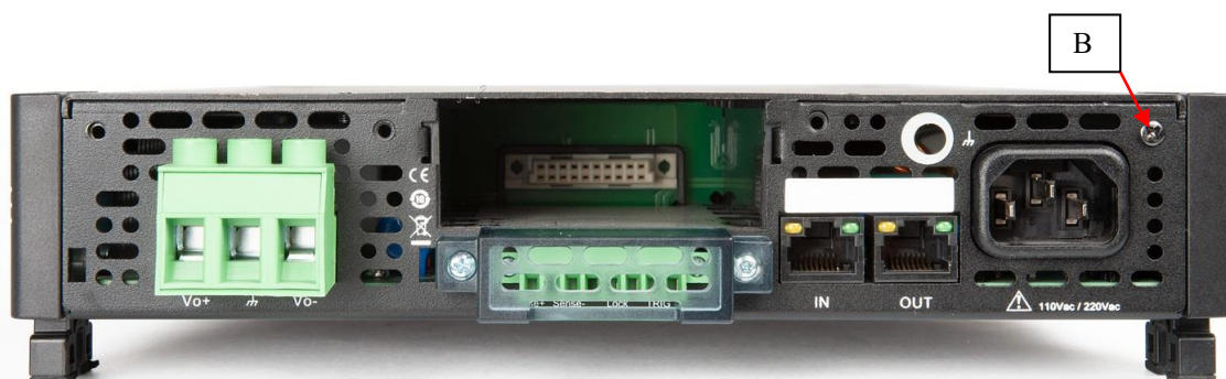
Рисунок 2 – Вид задней панели источников, место пломбировки от несанкционированного доступа (В)
