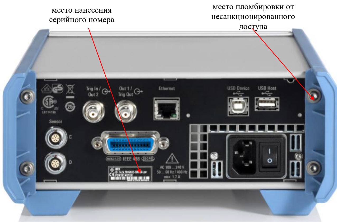
Рисунок 2 - Схема пломбировки от несанкционированного доступа и место нанесения серийного номера, идентифицирующего каждый экземпляр СИ
